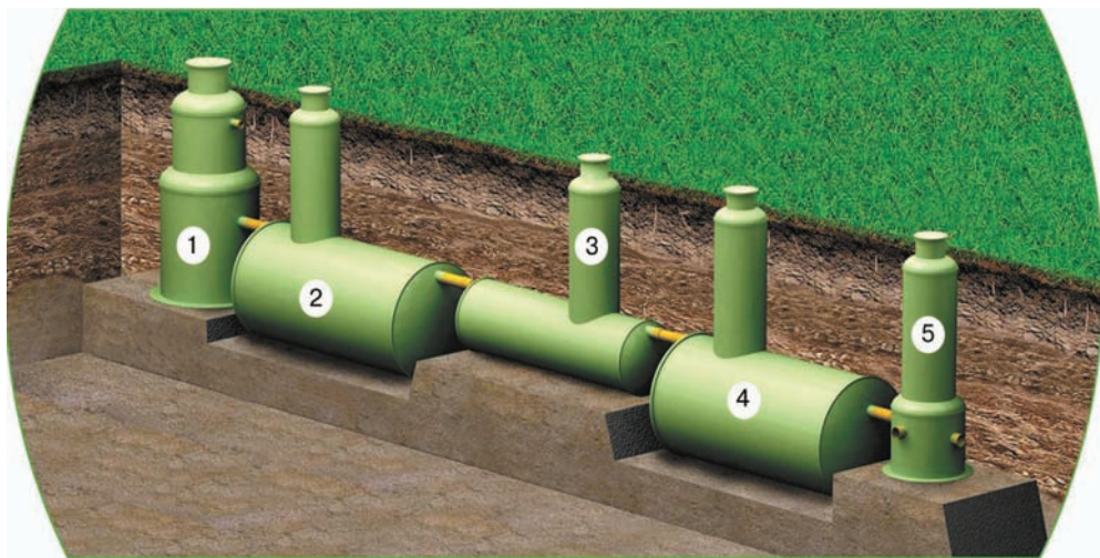
Мал. 6.4. Приклад сучасної очисної споруди: 1 – розподільчий колодязь; 2 – відокремлювач твердих часток; 3 – відокремлювач жировмісних речовин; 4 – сорбційний фільтр; 5 – контрольний колодязь
